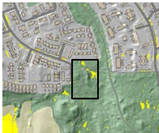
Skyfallskartering visar att det finns låglänta områden där vatten kan samlas inom fastigheten i dagsläget.
